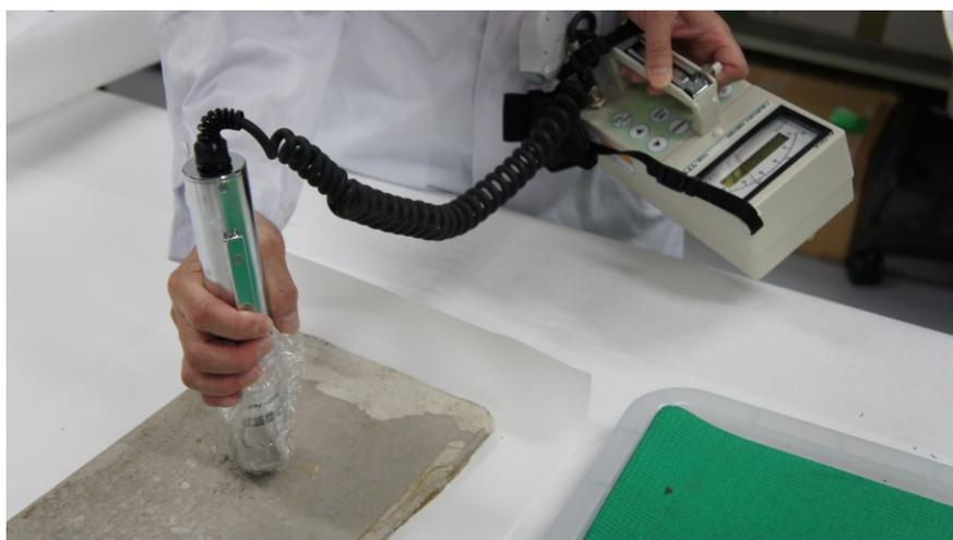
シンチレーションサーベイメーターで参考測定【単位 $\mu$ Sv/h】
